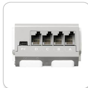
Conexión de motores
