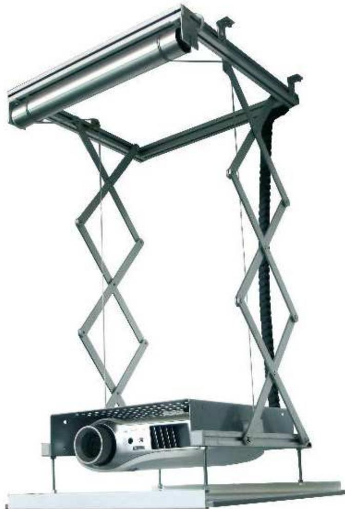
Soporte elevador motorizado para proyectores de gran calidad en aluminio anodizado. Apertura hacia abajo con extensión vía pantógrafos hasta 100 cm o 200 cm, permitiendo paradas intermedias. La plataforma inferior puede colocarse en 4 posiciones para que el soporte requiera sólo 15 cm de altura o dar cabida a proyectores de mayor tamaño. Dispone de un motor tubular silencioso para proyectores hasta 17 Kg.
