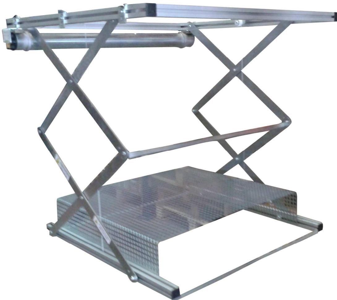
Soporte elevador motorizado para proyectores de gran tamaño en aluminio anodizado, con una excelente calidad. Apertura hacia abajo con extensión vía pantógrafos hasta 100 cm, permitiendo paradas intermedias. La plataforma inferior de mayor tamaño puede dar cabida a proyectores más grandes hasta 64 cm de anchura x 62 cm de fondo. Dispone de un motor tubular silencioso para proyectores hasta 17 Kg.
