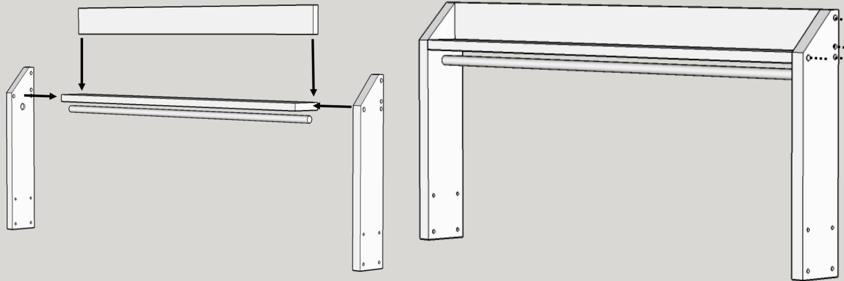
El primer paso es la construcción de los estantes. Utiliza 8 tornillos de 4,0x70 para fijar el estante y la parte posterior a las dos patas.
