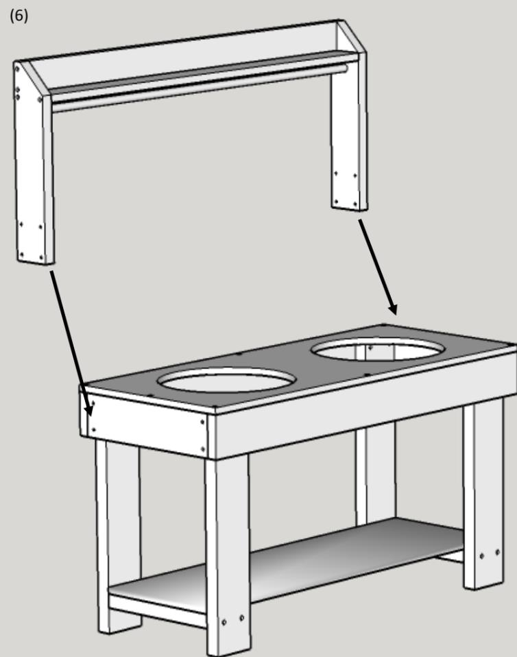
4. Monta los dos paneles laterales pequeños y fíjalos con tornillos 4,0x70. Hay cuatro por panel. Utiliza los agujeros piloto suministrados.
