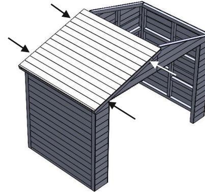
10. Fijar el techo usando 4 tornillos de 80 mm. como indica la foto superior.
