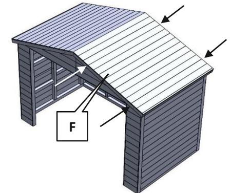
11. Fijar la otra parte del techo usando 4 tornillos de 80 mm. como indica la foto superior.
