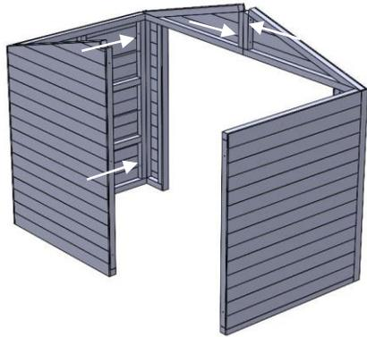
8. Fíjala las dos partes usando 4 tornillos de 80 mm.
