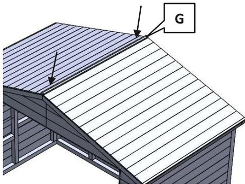
12. Coloca la parte G como en la imagen y fíjala con 2 tornillos de 60 mm.
