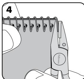
Utilize o alicate para cortar a extremidade da espiral metálica. Corte o excedente da espiral.
