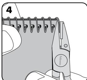
Utilice los alicates de corte para cortar del espiral. Corte lo que sobre.
