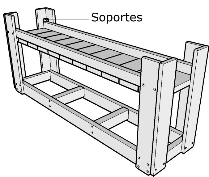
7. Fija los soportes a las patas usando tornillos de 3,5x16 mm.
