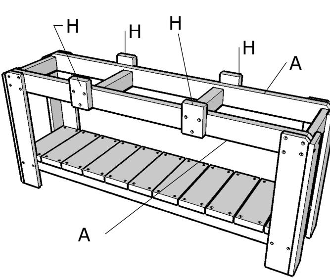
8. Atornilla las partes H a la estructura A usando tornillos de 4,0x55 mm.
