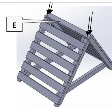
4. Coloca el vértice en la parte interior de la estructura como en la imagen superior y fija las partes con 4 tornillos de 90 mm.
