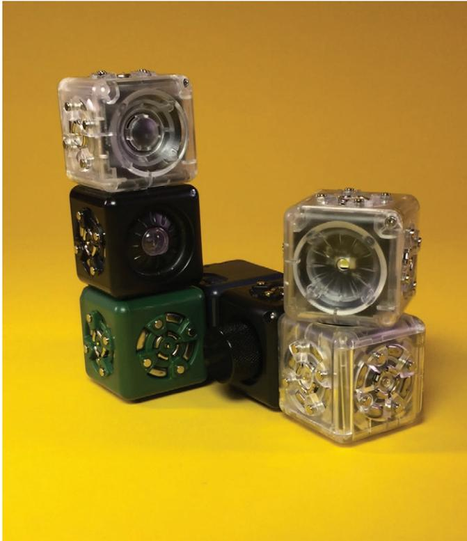
Ahora añade un cubo bloqueador de señal a la base (por ejemplo, en la batería). A continuación, en el otro lado del cubo bloqueador de señal agrega un cubo de acción de altavoz y, en la parte superior, coloca un cubo sensor de luminosidad con la cara del sensor apuntando hacia la luz giratoria. El cubo de acción de altavoz emitirá un pitido (si la habitación está muy iluminada).
