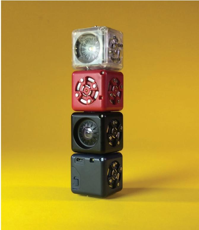
Coloca el cubo inversor rojo entre el cubo sensor de luminosidad y el cubo de acción de la luz. Recuerda cómo se realiza la transmisión de los valores: cada cubo de sentido transmite un valor. El cubo sensor de luminosidad transmite un valor alto cuando detecta mucha luz, a su vecino (el cubo de acción de la luz), que convierte el valor en una luz intensa.
