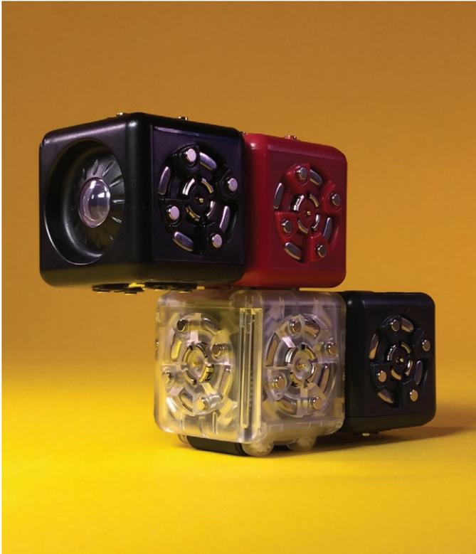
Cambia el cubo de acción de luz y pon un cubo de acción de movimiento en su lugar. Ahora has construido un robot que se mueve cuando está oscuro, y se detiene cuando hay luz.
