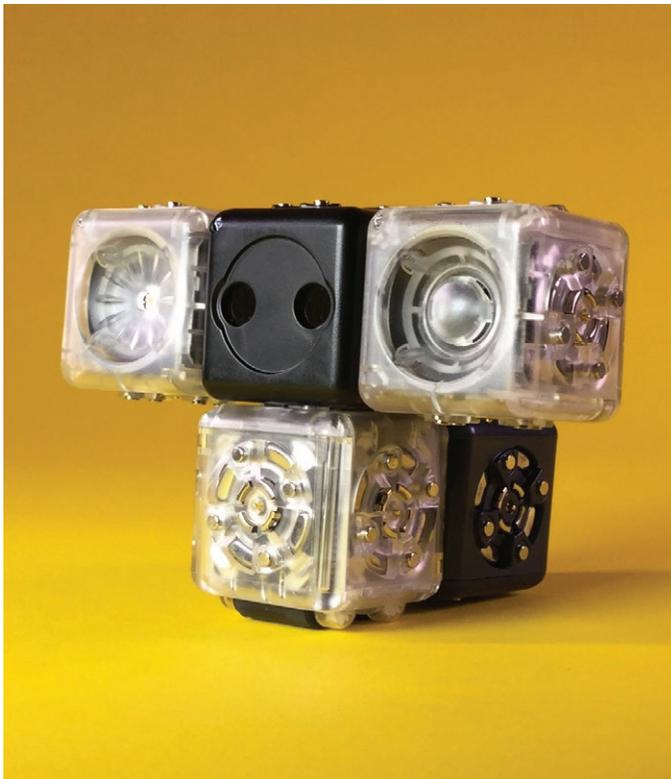
Construye un Gobot sencillo con un cubo sensor de luminosidad y un cubo de movimiento: se mueve cuando detecta luz.
