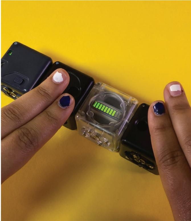
Si tu robot tiene dos cubos de sentido y un cubo de acción, ¿Qué cubo de sentido controla el robot? Construye un Testbot con dos cubos sensores de distancia y un cubo de acción de gráfico de barras entre ellos.
