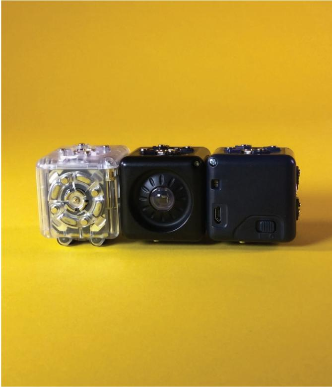
Este robot go-bot de intensidad de luz simple tiene un cubo de acción de movimiento (izquierda) que mueve al robot cuando su cubo sensor de luminosidad ve luz. El cubo gris de la derecha es el cubo de la batería.
