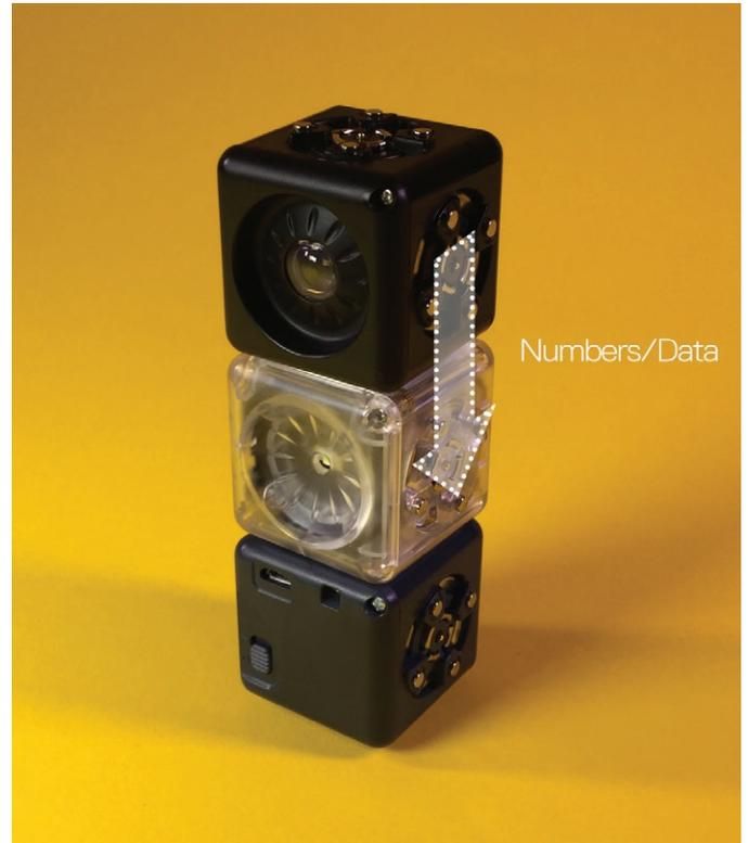
Un valor pequeño hace que la lámpara disminuya su luminosidad. Imagina al valor saltando o fluyendo de un cubo al siguiente. Los valores fluyen a través de los cubos del robot desde cubos de sentido hasta cubos de acción todo el tiempo. Eso es lo que determina el comportamiento del robot.
