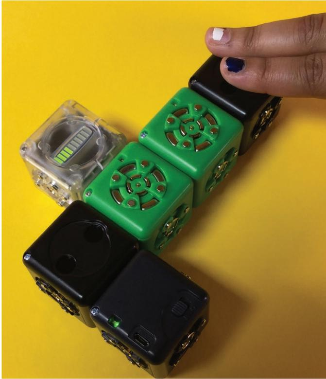
Este robot muestra la historia del gradiente. El cubo de acción de gráfico de barras se une a uno de los dos cubos pasivos entre dos cubos sensores de distancia, uno en cada extremo del robot. El cubo sensor de distancia más cercano tiene un efecto mayor en el cubo de acción de gráfico de barras. Si tu robot tiene un cubo de acción a la derecha entre dos cubos de sentido, el cubo de acción promedia los valores que los dos cubos de sentido le transmiten.
