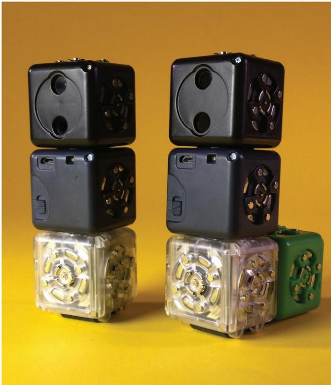
Si construyes este robot como una torre en lugar de un tren, sigue funcionando, pero ya no es estable: acércate al cubo sensor de distancia y el cubo de movimiento comienza a moverse. Si acelera demasiado rápido la torre se cae.
